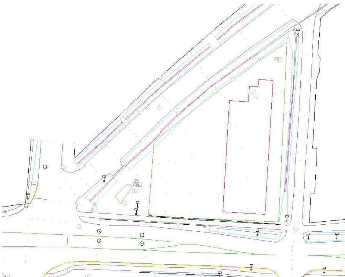
bemért épületkontúr geodéziával
